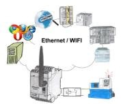
Schalten Sie mit dem EtherSens Control mit Relais-Ausgang bequem und direkt über LAN oder WIFI bis zu 230VAC/16A, schaltbar über Web-Browser, TCP/IP-Protokoll oder SPS-gesteuert. Gleichzeitig protokollieren Sie die Schaltzustände auf der optionalen SD-Karte oder über den FTP-Server.
