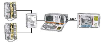
Sie müssen mit mehreren SPS-Steuerungen arbeiten, haben aber keine Lust sich dauernd ab- und anzustecken? Kein Problem, Sie schließen ein Gerät der AG-Switch-Serie an den SPS-Steuerungen sowie Ihren PC/PC an und schon können Sie mit den Steuerungen kommunizieren. Die Auswahl des entsprechenden Teilnehmers führen Sie beim AG-Switch-I mittels Kippschalter und beim AG-Switch-II per 24V-Steuereingang durch.
